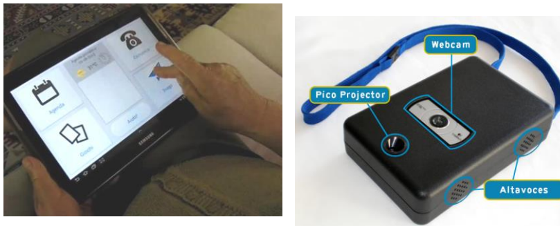
Figura 3. Dispositivos interfaz: la tableta (izquierda) y el prototipo DCPAR (derecha).
